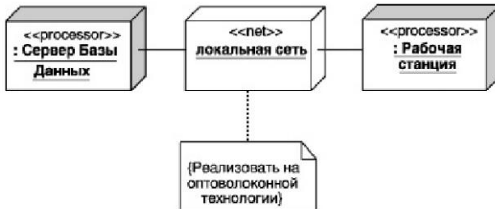
Рис. 13.5. Фрагмент диаграммы развертывания с соединениями между узлами
